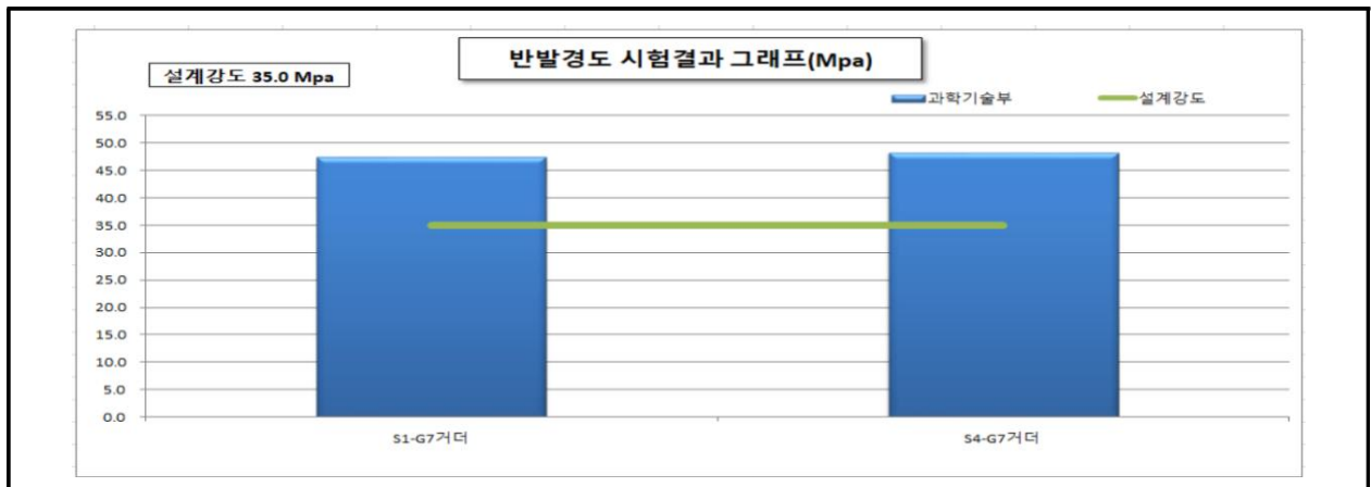
【그림 1.4.3】반발경도시험(상부구조 고강도)
